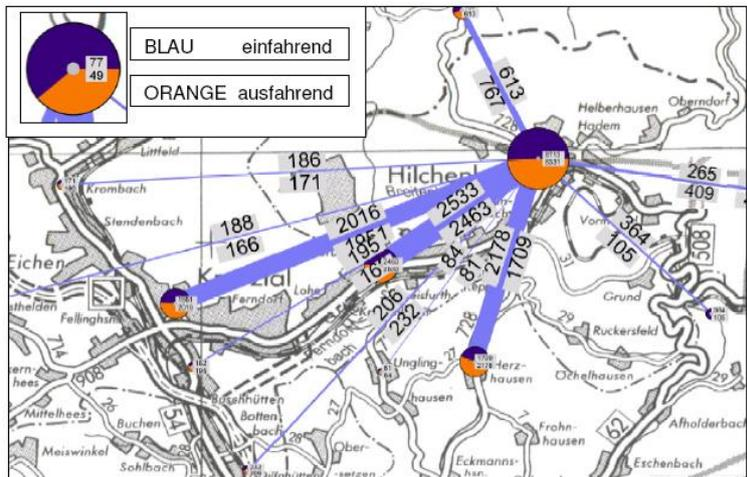
**Knotenstrompläne** von einzelnen oder mehreren Knotenpunkten verdeutlichen die Fahrbeziehungen an Kreuzungen oder Einmündungen. Dabei wird die Geometrie des Knotenpunktes beachtet; die Einstellungen für Radiengröße, Maßstab oder Schriftgröße können individuell erfolgen oder über ein automatisches Layout vom Programm berechnet werden.
